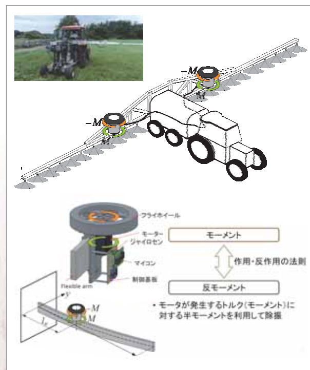
開発したフライホイールを用いた回転型除振装置を適用したブームスプレーヤー
