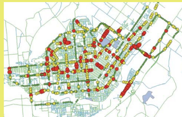
STAMPERによる平坦性の測定結果をGISを利用しデジタル道路地図上にプロット
